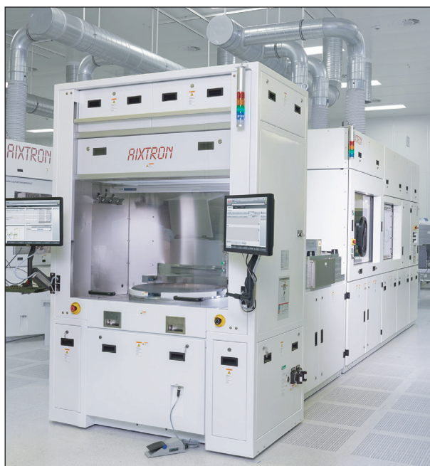
Aixtron's new AIX R6 MOCVD system.
