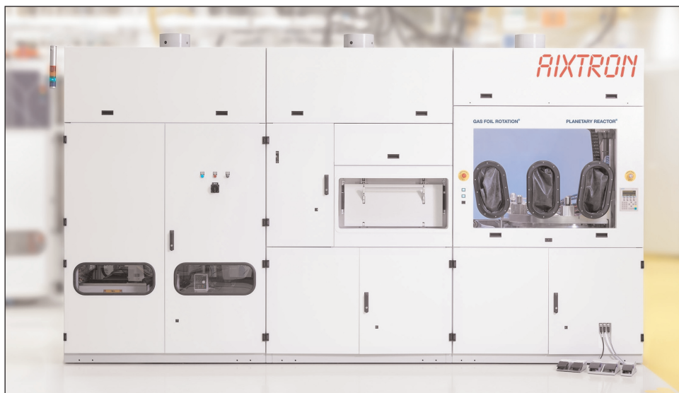
Aixtron's AIX G5 WW (Warm-Wall) CVD system.
