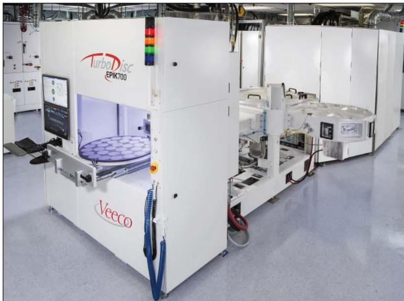
以来, Veeco公司的市场份额已稳步增加,成为MOCVD薄膜工艺设备的全球领导者。2011年, Veeco公司推出了据说是业内首款多反应器的MOCVD系统, TurboDisc超亮GaIn多反应器MOCVD系统。
