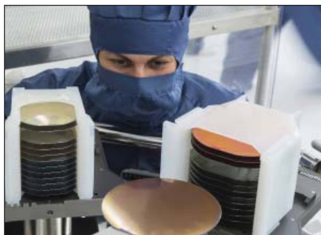
欧司朗光电的装配系统在传送6英寸晶片, 可以在左边看到4英寸晶片。
