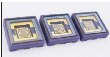
日机装的深紫外LED的封装。
